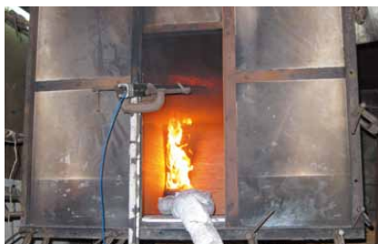
試験結果 評価基準 発熱速度140kW以下 総発熱量50MJ以下
