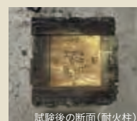
試験後の断面(耐火柱)
