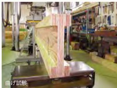
キーラム メガビームは集成材・製材より小さな断面で、同等の曲げ剛性を持ちます。曲げ試験により性能を確認しています。
