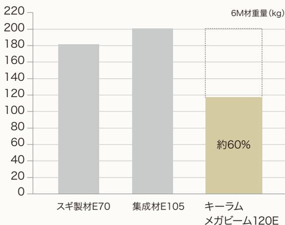
キーラム メガビームの重量は同じ曲げ性能の集成材の約60%と、軽量のため設計、運搬、施工の際に扱いやすい部材となっております。
